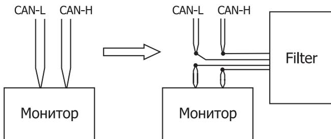
Рис. 3. Схема разрыва двояной шины CAN.
